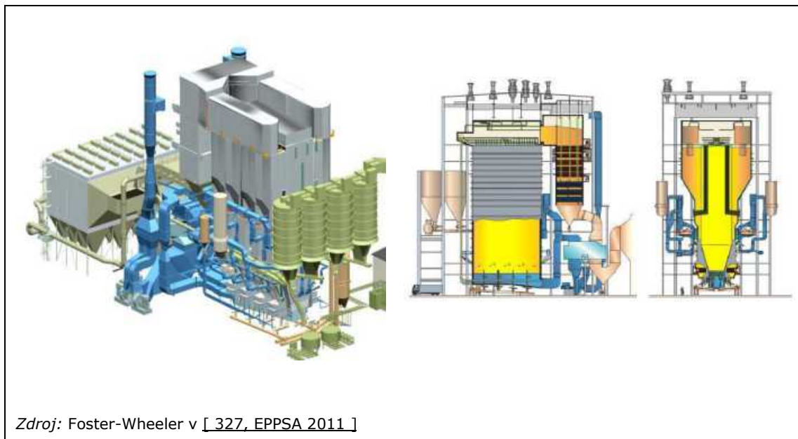
Obrázok 2.6: CFBC zariadenie pre vysokú účinnosť (Lagisza, 966 MW th , 361/306 kg/s, 275/50 bar, 560/580 °C)
