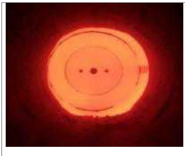
Obrázok 11.7: Typický obrázok spaľovania dosiahnutého bezplameňovým horákom
