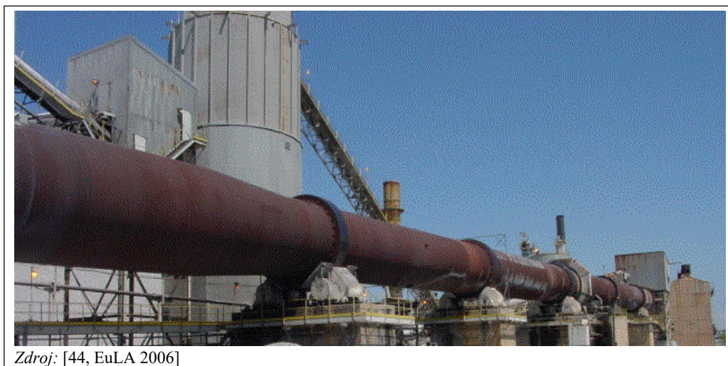
Obrázok 2.31: Príklad dlhej rotačnej pece používanej pri výrobe vápna
