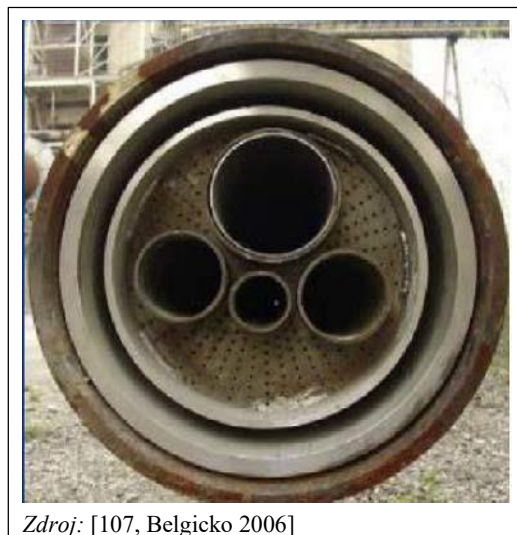
Obrázok 1.11: Príklad viackanálového horáka
