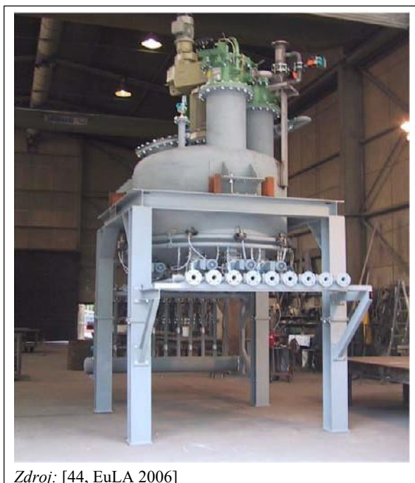
Obrázok 2.11: Príklad dávkovacieho systému v šachtovej peci
