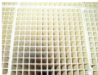
Obrázok 1.67: Príklad individuálneho katalyzátora používaného pri technike SCR Zdroj: [140, Taliansko 2007]
