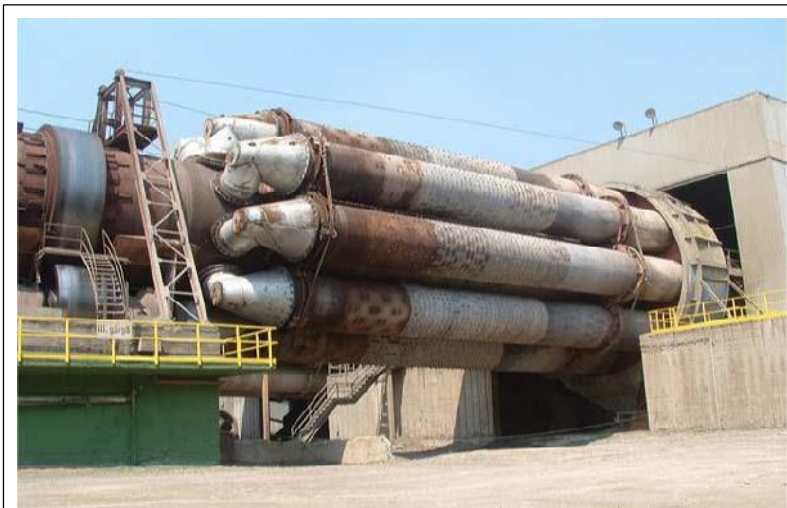
Obrázok 1.18: Príklad planetárneho chladiča
