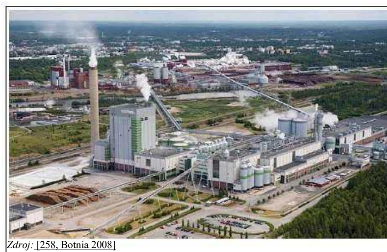
Obrázok 1.22: Letecký pohľad na integrovaný závod na výrobu sulfátovej buničiny, mechanickej buničiny a papiera s kotolňou a čističkou odpadových vôd
