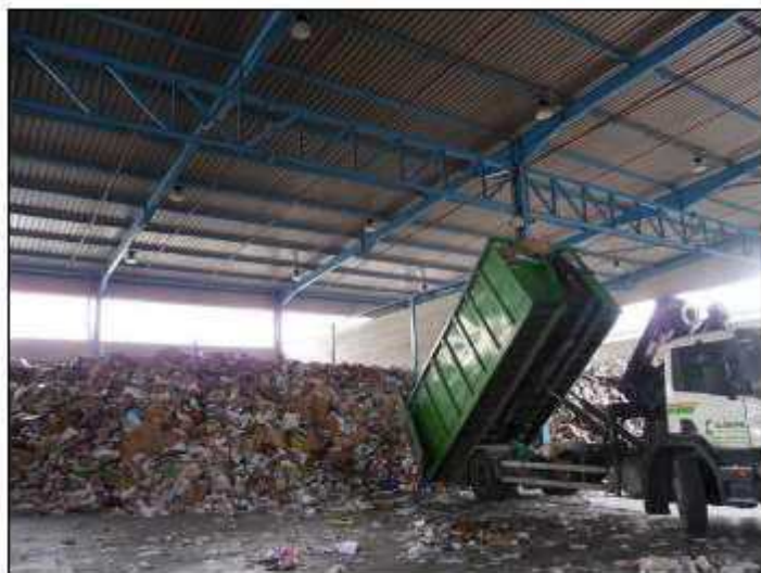
Obrázok 6.29: Vykladanie a skladovanie voľného zberového papiera v uzavretom krytom zariadení
