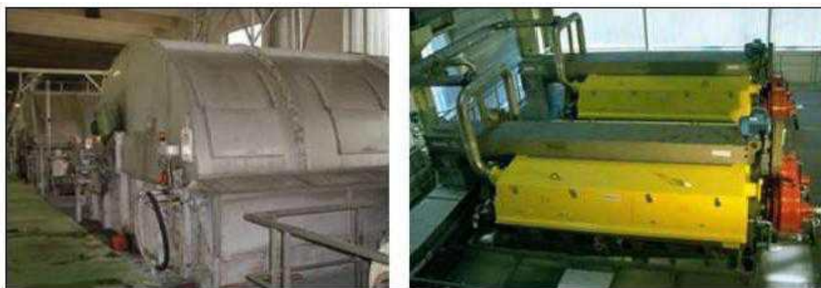
Obrázok 4.6: Príklad filtra na premývanie (vľavo) a lisu na premývanie (vpravo) v procese premývania nebielenej buničiny
